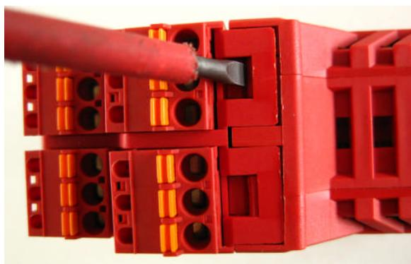
3. ...und gleichzeitig nach hinten drücken. Jetzt kann man wenn man diesen Schritt mit allen 4 Verschlüssen wiederholt den Gehäusedeckel abziehen.
