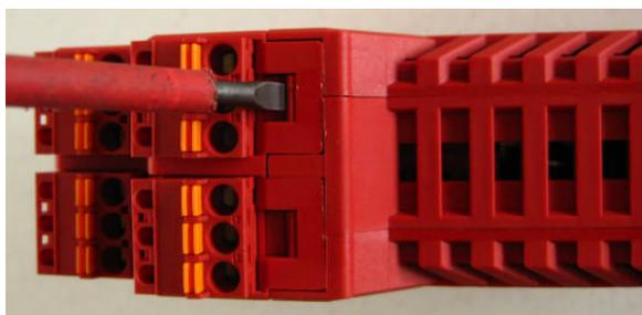
2. den mit dem Schraubendreher gedrückten Splint nach hinten über die eingerastete Verschlusslasche schieben...
