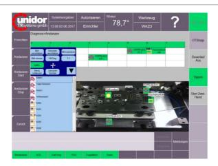
Zur Programmierung werden lediglich alle Sensoreingänge, mit moderner "drag and drop" Technik, grafisch im entsprechenden Werkzeugraum platziert. Die komfortable, selbstlernende Werkzeugsicherung und Prozessüberwachung gewährleistet die Überwachung der geforderten Eingangssignale.
