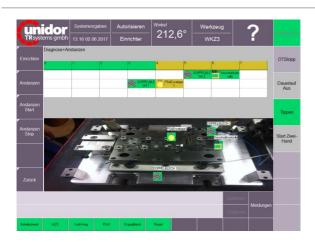
Mit der Funktion Anstanzen ist ein sicherer Anlaufprozess gewährleistet. Hier werden die Sensoreingänge nach erfolgtem Signalwechsel automatisch vom überbrückten in den überwachten Modus umgeschalten. Die manuelle Aktivierung ist somit nicht mehr erforderlich.
