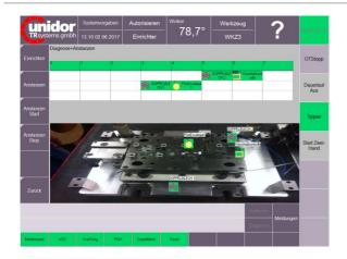
Die grafische Darstellung des aktuell im Prozess befindlichen Stanzwerkzeuges lässt eine sofortige und auf einen Blick lokalisierbare Fehlerdiagnose zu. Durch die grafische Sensorprogrammierung werden Fehlprogrammierungen nahezu ausgeschlossen.
